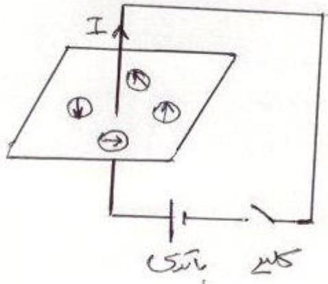
اورستد مدار ساده ای مطابق شکل ایجاد کرد، با بستن کلید و ایجاد جریان در سیم متوجه شد که عقربه های مغناطیسی از موقعیت قبلی خود چرخیده و به صورت شکل قرار گرفتند. از این آزمایش نتیجه گرفت که ایجاد جریان در سیم باعث ایجاد میدان مغناطیسی در اطراف آن شده و به عقربه های مغناطیسی نیرو وارد کرده است.
